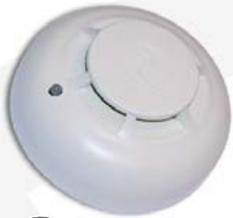
El detector termovelocimétrico algorítmico de Aguilera Electrónica AE/SA-T es un detector de calor que gestiona dos parámetros de temperatura, uno diferencial que toma las medidas del incremento de temperatura en tiempo y otro término que controla la temperatura ambiente que detecta en cada momento. Tanto el parámetro diferencial como el térmico son analizados y enviados a la central para esta de la señal de alarma de acuerdo con la programación hecha en cada caso.
